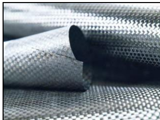
mit PEKK bepulvertes Gewebe nach anschl. Aufschmelzen
